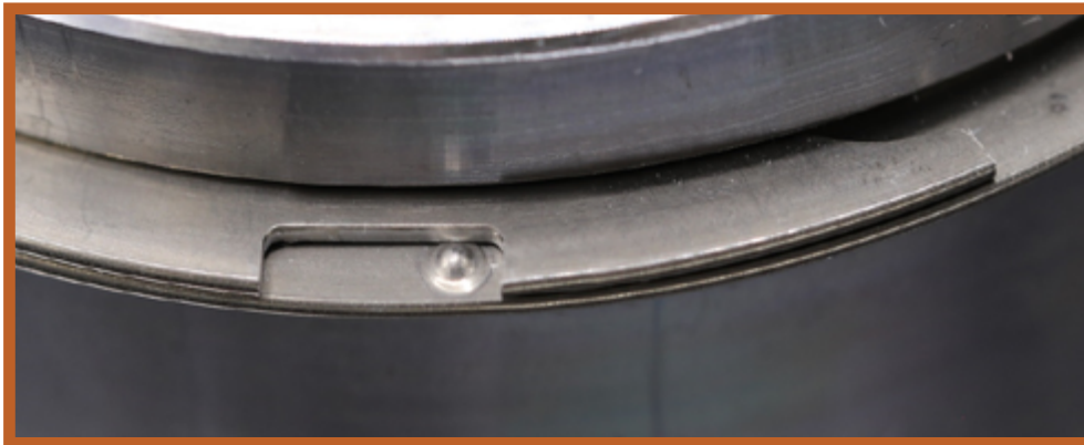
Abb. 4. Noppe und Aussparung verhindern, dass der Ring bei hoher Drehzahl aus der Nut gehoben wird.
