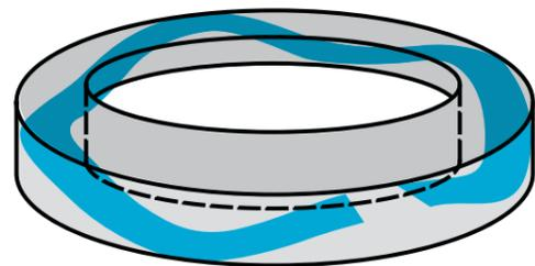
eine berührunglose Führung der Feder bei den unterschiedlichen Lasthöhen gewährleistet. Dadurch wird ein Kratzen auf der Wellen- und/oder Bohrungswandung vermieden. Falls notwendig, ist ein leichtes Klemmen ebenfalls zu realisieren.
